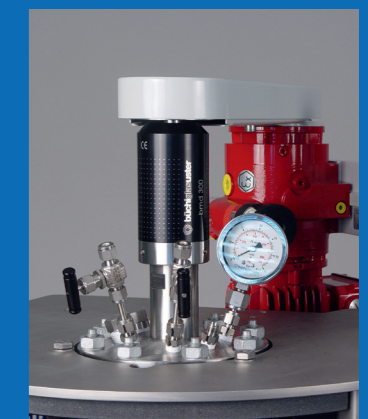
bmd 300 with ATEX drive on polyclave bmd 300 mit ATEX Antrieb auf polyclave
