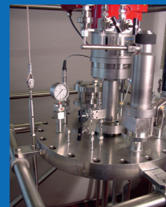
bmd 1800 on 100 liter Hastelloy reactor bmd 1800 auf 100 Liter Hastelloy Reaktor
